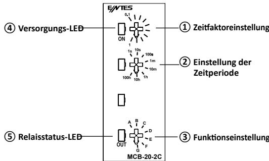
**① Zeitfaktoreinstellung:** Faktor, das mit der gewählten Zeitperiode multipliziert wird. Kann mit dem Trimpot auf dem Gerät zwischen 0,1 und 1 eingestellt werden.
