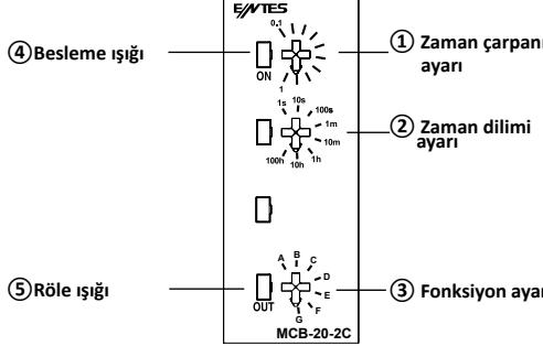
**① Zaman Çarpanı Ayarı:** Seçilen zaman diliminin çarpılacağı zaman çarpanıdır. Cihaz üzerinde bulunan ayar trimpotu ile 0.1'den 1'e kadar ayarlanır.
